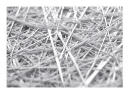
Стекломат служит для ремонта значительных повреждений автомобильных кузовов, лодок, яхт, кемпинговых прицепов и т.д. Ремонтируемые элементы могут быть сделаны из стали или GRP (слоистый пластмасс) усиленных стекловолокном. Полученные слои обладают отличной адгезией к различным поверхностям, устойчивы к воздействию бензина, масел, смазок, а также кратковременному воздействию высоких температур, до 70°C.
